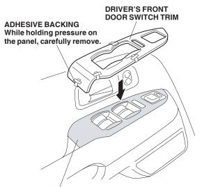
DRIVER'S FRONT DOOR SWITCH TRIM ATTACHING SURFACE
